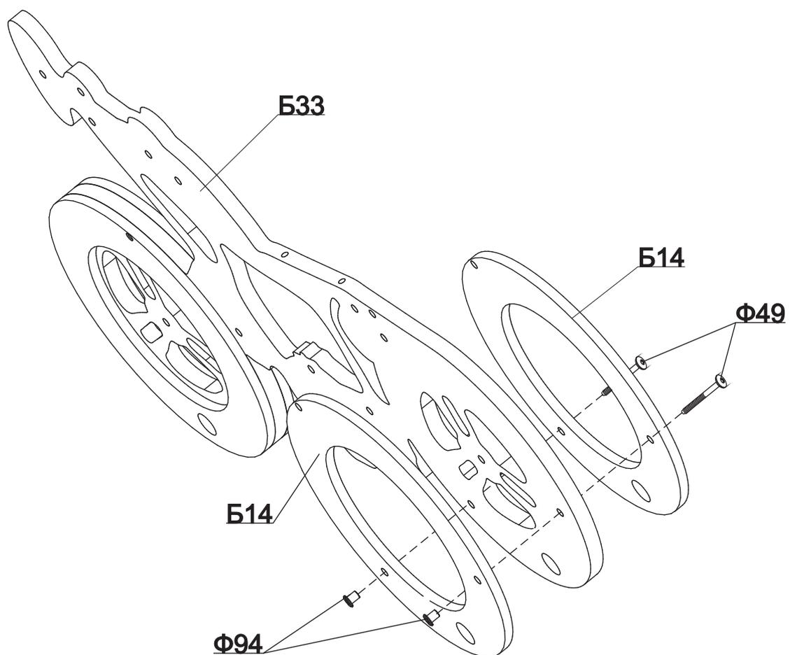
**3** Сборка опоры качалки
